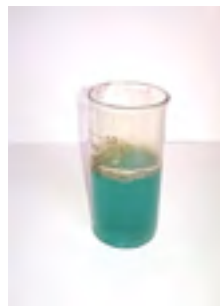
Рис. 2. Растворение сплава в разбавленной азотной кислоте
