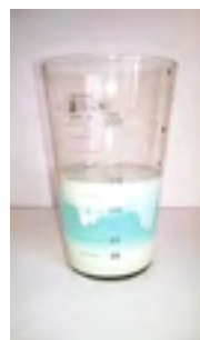
Рис. 4. Осаждение ионов серебра
