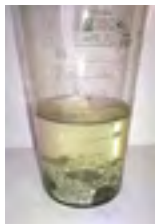
Рис. 6. Восстановление хлорида серебра (I) цинком
